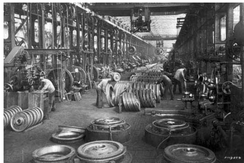
Kruppsche Radsatzwerkstatt, 1906-1914, Gelände Südseite der Pferdebahnstraße, Werkstätten zur Bearbeitung von Radreifen und Radstern zum Zusammenbau der Radsätze Foto: Stadtbildstelle Essen
